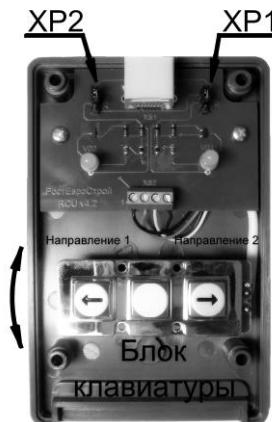
Вид пульта со снятой крышкой
